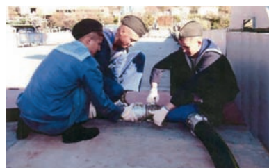
Операторы насосных установок готовят рукава ПКБО-200 для групповой заправки кораблей
